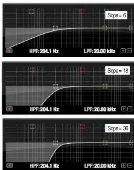
Рис. 10-25: НЧ фильтр с тремя примерами установок спада (крутизны АЧХ).
