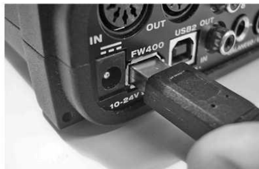
Рис. 4-1: Подключение UltraLite-mk3 к компьютеру через FireWire.
