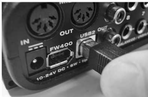
Рис. 4-2: подключение UltraLite-mk3 к компьютеру через USB.
