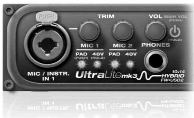
Рис. 6-1: На передней панели mic/guitar входы и гнездо телефона.
