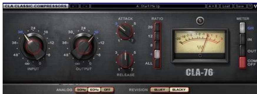
Параметры компрессора: атака, восстановление и соотношение
