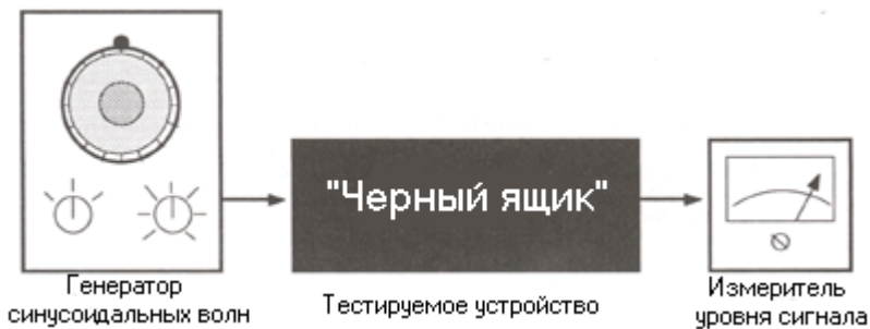
Рис. 2.1. Система для измерения частотной характеристики
