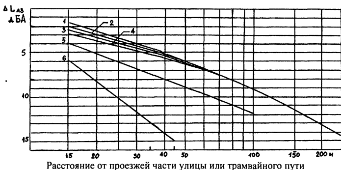
Рис. 23.1. Снижение уровня звука с увеличением расстояния 1 – улица две полосы движения; 2 – улица четыре полосы движения; 3 – улица шесть полос движения; 4 – улица восемь полос движения; 5 – трамвай ( L_{\text{экв}} ); 6 – трамвай ( L_{\text{макс}} )
