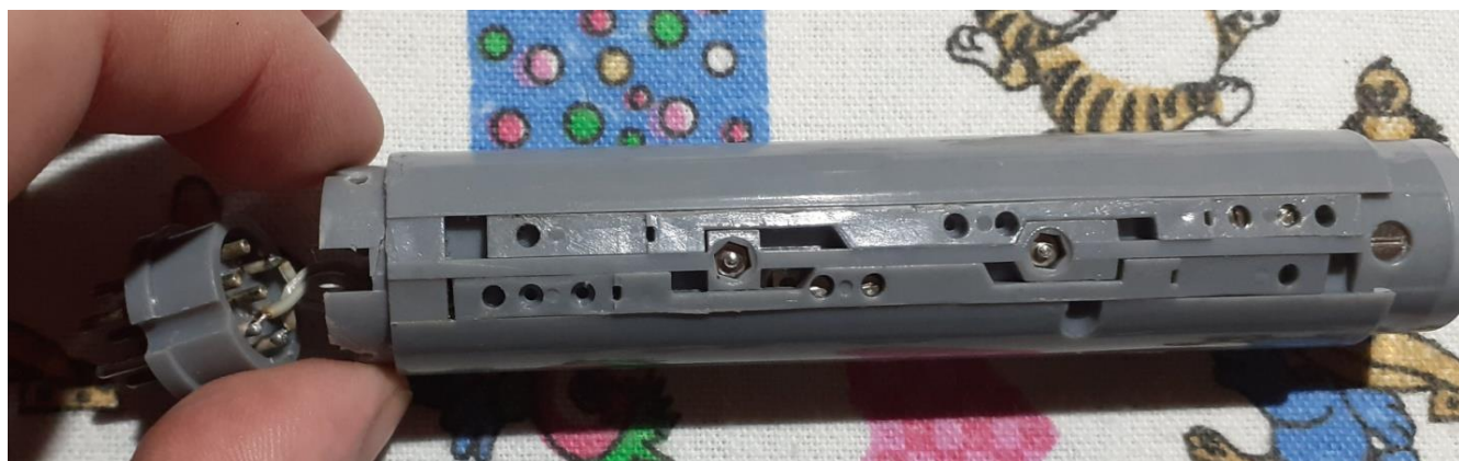
Аккуратно с толкателями переключателей! Они просто уложены в пазы. Винтики придерживают подпружиненные контакты (винты до упора не затягивать!!!)
