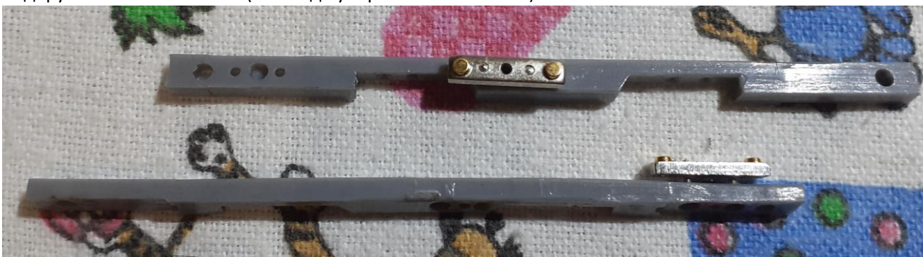
Аккуратно с толкателями переключателей! Они просто уложены в пазы. Винтики придерживают подпружиненные контакты (винты до упора не затягивать!!!)
