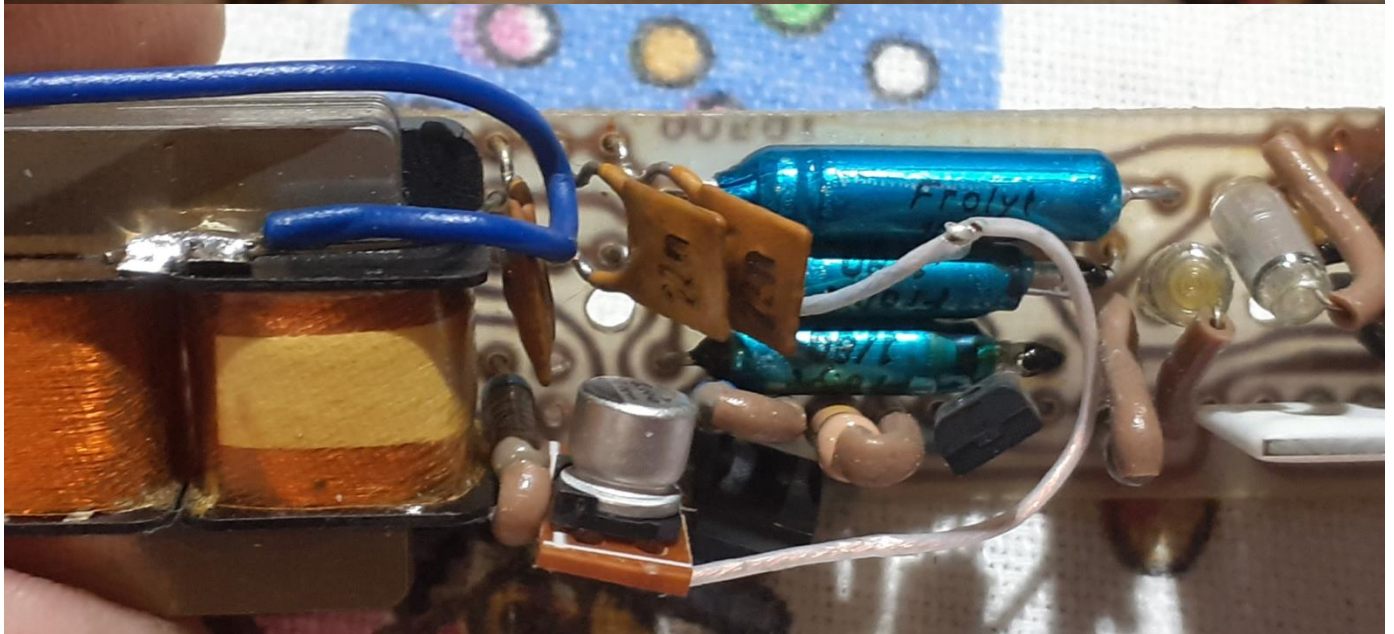
Обрезанный XLR-F на месте родного разъёма типа tuchel
