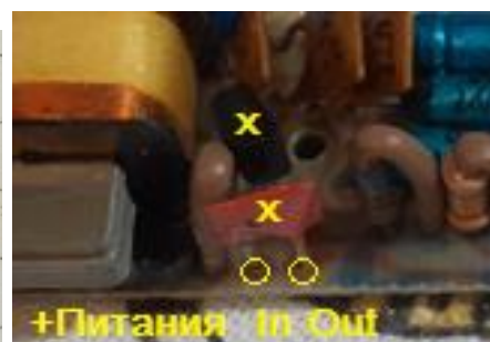
Микросборка установлена на место изъятюго спаренного диода и конденсатора.
