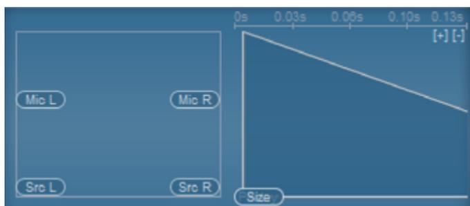
Правый и левый источники звука обозначены **Src L** и **Src R**, а микрофоны — **Mic L** и **Mic R** соответственно. Например, если вы отодвинете источник далеко от микрофона, его звук послышится дальше; с увеличением задержек звук станет рассеивающимся и сложным. Одновременно исчезнут резкие первые отражения. Этот инструмент обладает огромным потенциалом, и его можно автоматизировать.
