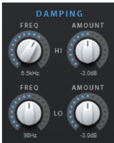
Кроме того, модели **HQ** позволяют настраивать приглушение верхних частот и время реверберации для басового диапазона нижних частот. Настраивая частотный спектр, вы сможете имитировать различные поверхности стен. Например, деревянные стены не только отражают нижние частоты хуже бетонных, но также могут резонировать или поглощать энергию длинноволновых нижних частот.
