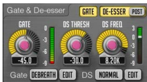
Параметр «DS Thresh» определяет пороговый уровень деэссера. Сигналы выше этого уровня будут компрессироваться. Деэссер работает в режиме боковой цепи: он не расщепляет полосы, но использует сигнал полосового фильтра в качестве ключевого сигнала для активации деэссера. В сущности - это широкополосный алгоритм деэссинга.
