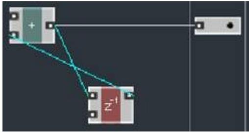
Но эти структуры уже различны, потому как неявной обратной связи уже нет. Значит в макросе **Z<sup>-1</sup>** должна быть какая-то дополнительная функциональность, и это так и есть. Рассмотрим структуру этого макроса:
