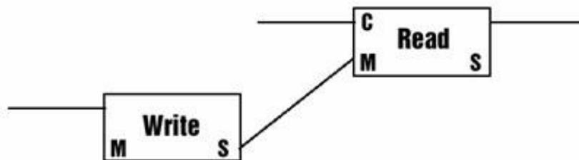
На рисунке изображена структура макроса **Latch** (фактически это внутренняя структура этого макроса). **M** и **S** порты модуля **Read** и **Write** это порты типа ОВС. **M** – обозначен главный вход (master), **S** (slave) – подчиненный выходной порт. Главный входной порт модуля **Read** соединен с подчиненным выходным портом модуля **Write** (другие два master/slave порта не задействованы). Таким образом, в
