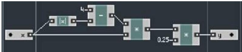
Здесь использованы обычные арифметические модули, а не модули-модуляторы, потому как здесь ведется обработка аудиосигнала, и аудиосигнал всегда посылает событие инициализации (т.о. разницы между макросами модуляции и арифметическими модулями здесь нет – можно использовать любые).
