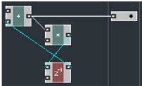
Видно, что большая оранжевая буква Z исчезла. Теперь заметим, чем односемплерная задержка отличается от такой же задержки вставленной автоматически: автоматическая задержка была установлена на проводе идущего от сумматора до входного порта умножителя, а теперь задержка происходит после выходного порта умножителя. Значение второго порта модуля  $Z^{-1}$  будет объяснено позже (здесь его можно оставить неподключенным).
