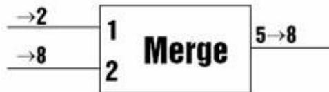
Здесь существует определенное правило для модуля **Merge**: события, прибывающие на два входных порта одновременно, обрабатываются в (обратном???) порядке нумерации входных портов (см. на рисунке порты обозначены 1 и 2). Выходным портом генерируется только одно событие, потому как порт модуля не может генерировать два события одновременно. В этом случае событие из второго входного порта будет произведено выходным портом после первого события, заменяя значение 8 новым значением 2.
