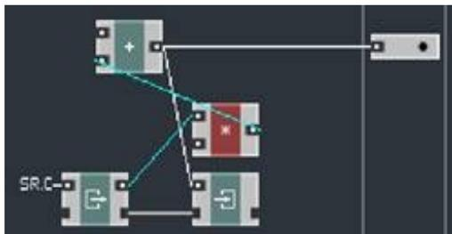
Итак, сначала мы пишем, и только затем читаем (заметим, что модуль **Read** синхронизирован по шине SR.C, то есть чтение будет совершаться один раз на отсчет аудио). Это делает прочитанное значение всегда на один семпл позади значения записи. Сейчас в
