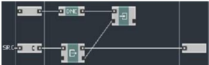
Модуль чтения синхронизирован по шине SRC (т.е. с частотой обработки аудио). Значение порта **C** по умолчанию – не ноль, а сигнал синхронизации аудио (модуль **DNC** рассматривается позже). Каким же образом механизм разрешения петель знает, что в данной структуре нужно осуществить разрешение обратной связи? Этим управляет установка **Solid** в свойствах макроса.
