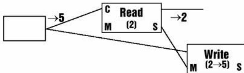
Теперь рассмотрим противоположный случай. Сначала, сигнал clock прибывает в модуль **Read**, который читает память и посылает в выходной порт событие со значением 2. Только после этого модуль **Write** изменяет значение памяти на 5. Эта структура реализует
