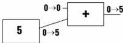
На рисунке выше, модуль сумматора получает два одновременных события инициализации, одно с присоединенной константы, а другое с константой по умолчанию верхнего порта.
