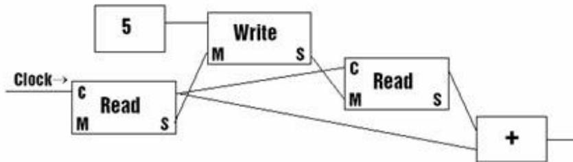
Модуль **Read** слева соединен с некоторым источником синхросигнала, который также посылает событие инициализации (источники синхросигналов обычно так и делают). Первоначально все сигналы выходных портов и внутренние состояния цепочки **Read-Write-Read** установлены в ноль.
