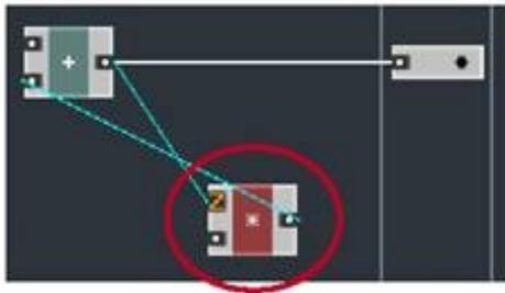
Мы уже видели структуру, реализующую эту  $Z^{-1}$  задержку, в которой были использованы модули **Read** и **Write**. Давайте попытаемся вставить эту конструкцию в нашу структуру. Мы вставим ее на провод в то место, на котором это разрешение имело место:
