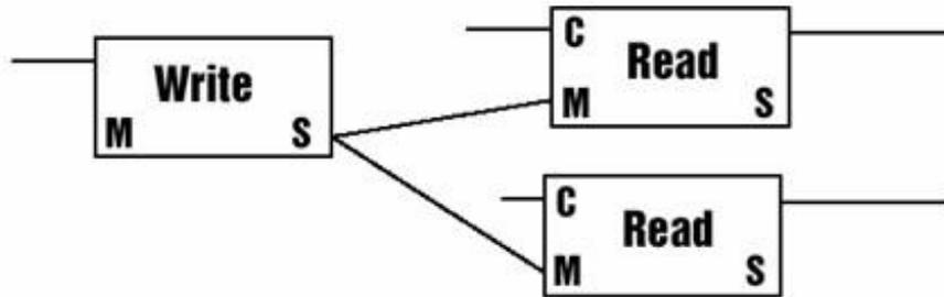
В следующей структуре относительный порядок первой и второй операции чтения также не определен. Эта структура может быть потенциально опасной (и таких структур нужно избегать):
