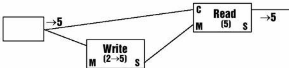
Рисунок выше изображает первый случай. Левый модуль посылает событие со значением 5, которое сначала достигает модуля **Write** потому как он главный. Значение 5 записывается в разделяемую память. Далее, событие прибывает на модуль **Read** в качестве сигнала синхронизации (clock), и заставляет модуль совершить операцию чтения из памяти. Таким образом, на выходной порт модуля **Read** посылается событие со значением 5. Именно так работает макрос **Latch** библиотеки Reaktor.
