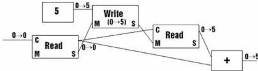
Левый модуль **Read** обрабатывается до модуля **Write** и поэтому событие от модуля синхронизации прибывает до того как новое значение будет записано в память, поэтому выходной порт этого модуля **Read** выдаст ноль. Затем значение будет записано в память модулем **Write**. Теперь второй модуль **Read** произведет чтение и выведет в выходной порт уже другое значение – 5. И, наконец, модуль-сумматор выведет значение 5.
