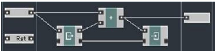
Заметим, что модуль **Read** синхронизируем по входящему событию, и, конечно, он расположен ниже по потоку (то есть в режиме ведомого) нежели ОВС-связанный с ним модуль **Write**, для того чтобы чтение памяти производилось до записи. На рисунке выше изображена структура реализующая это.
