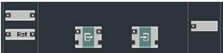
Модуль слева – это **Read**, справа – **Write**. В ответ на входящее событие аккумулятор должен взять текущее значение из памяти и прибавить к нему значение пришедшего события (а также записать новое значение в память). Таким образом, мы используем модуль **Read** чтобы узнать текущее состояние счетчика, далее используем модуль сумматора чтобы добавить новое значение к нему, и в конце модулем **Write** запишем полученную сумму.
