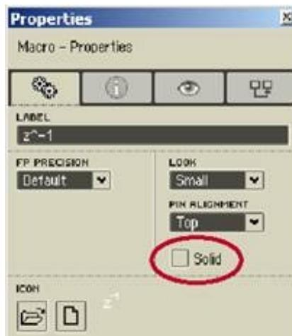
**Solid** (переводится как – твердый) говорит движку Reaktor Core нужно ли рассматривать макрос как встроенный модуль в случаях разрешения обратных связей. В 99% случаях нет необходимости снимать здесь галочку, и разрешать петли обратной связи внутри макроса. Хорошая практика – не разрешать цепи в макросах (такое разрешение довольно неудобно: вы не увидите, что в структуре есть глобальная обратная связь, пока не отобразите структуру макроса).
