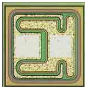
Рис. 2. Топология кристалла биполярного транзистора N-P-N (BC337/BC817)
