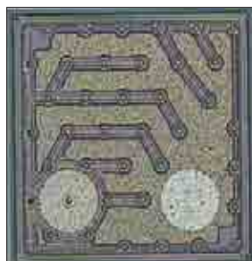
Рис. 4. Топология эмиттерного электрода BISS-транзистора 2-го поколения
